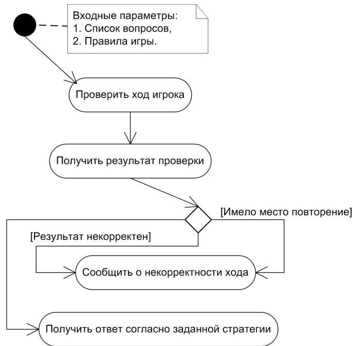
Рис. 8. Диаграмма деятельности, описывающая последовательность действий при вызове операции «Получить ответ от соперника»
