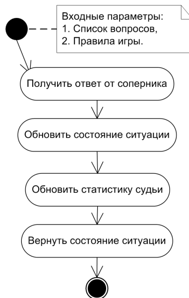
Рис. 7. Диаграмма деятельности, описывающая последовательность операций при выполнении операции «Совершить ход» на объекте типа «Игрок»
